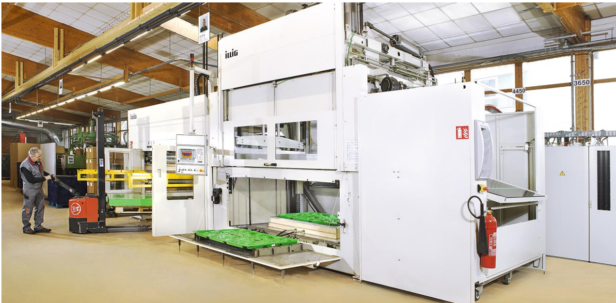
Abbildung 3: Plattenformautomat ILLIG UA 250-4g
