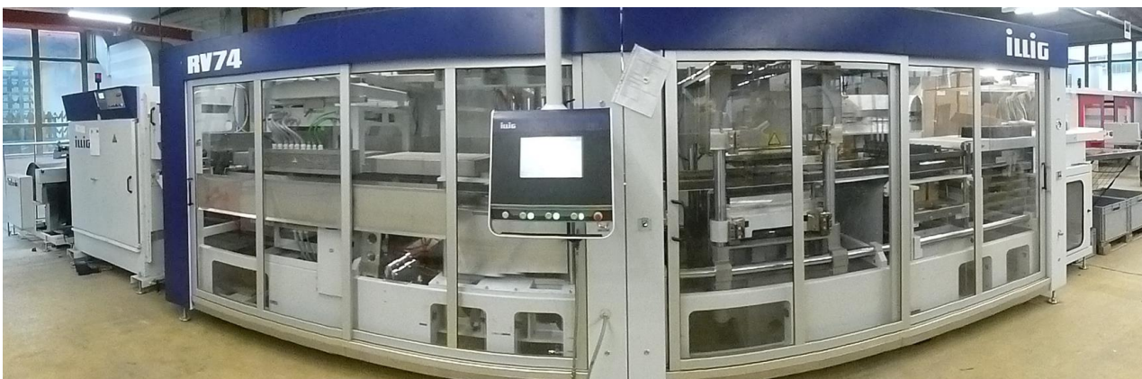
Abbildung 2: Rollen-Vakuumformautomat ILLIG RV 74d
